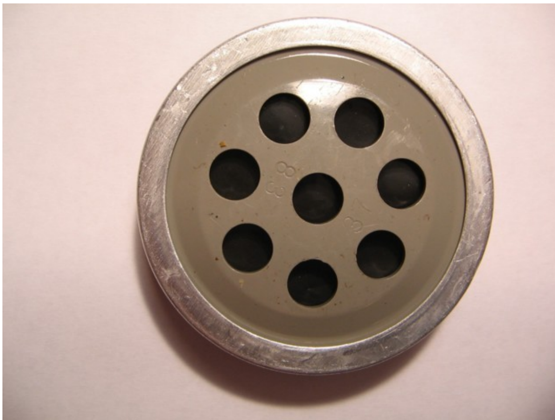
Típico micrófono de carbón extraído de teléfono de disco
